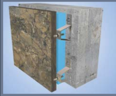
Rozsdamentes tartószerkezettel rögzített gránit homlokzat Granite facade mounted with galvanized iron fixing elements
